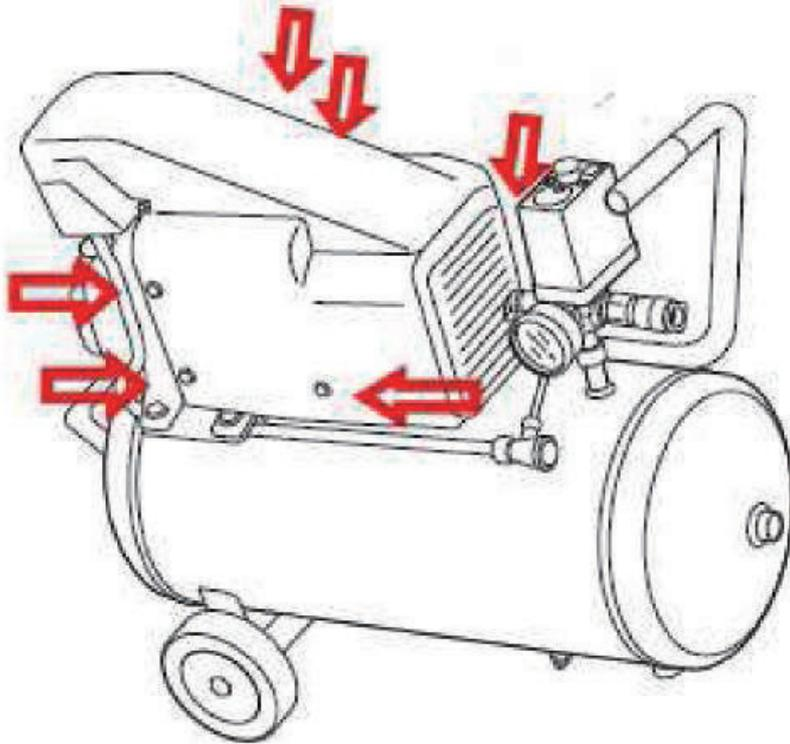
Usando una pinza o, meglio, una chiave regolabile, ruotare l'asse del motore che spunta dalla ventola per 90° in un senso e 90° nell'altro senso, per un paio di volte.
